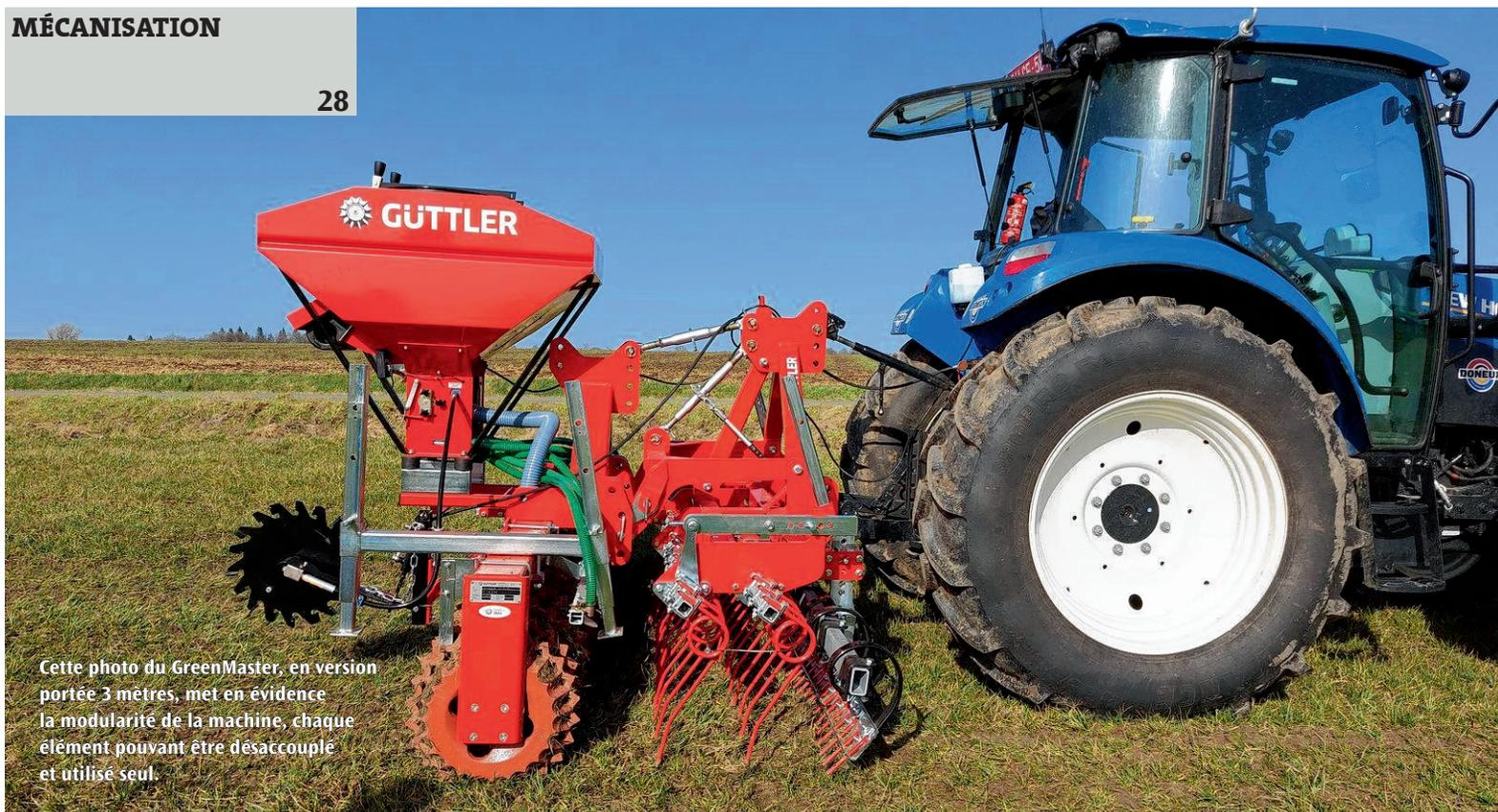
Cette photo du GreenMaster, en version portée 3 mètres, met en évidence la modularité de la machine, chaque élément pouvant être désaccouplé et utilisé seul.
