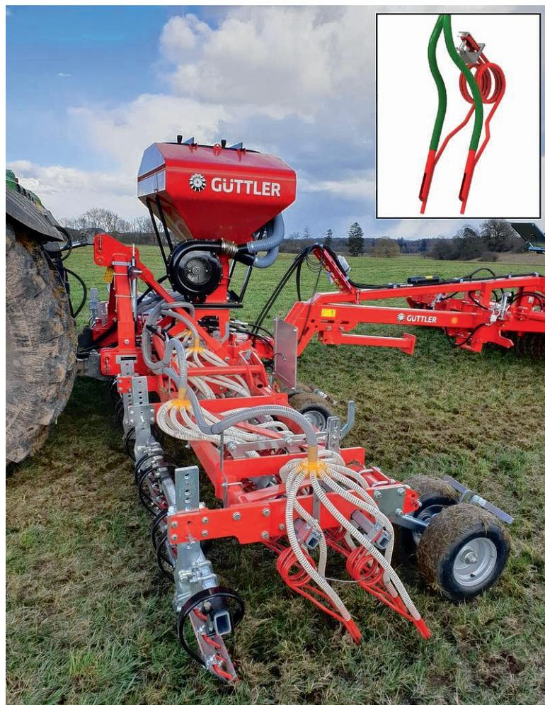
La dent semeuse brevetée Güttler conduit sans encombre la semence sous une végétation haute ou humide, tout en reproduisant un semis à la volée.
