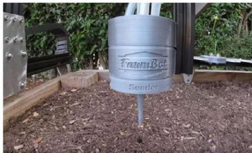
4-5 hectares. » Actuellement, le portique monté sur deux rails latéraux peut travailler sur des superficies de 3 mètres sur 9 et pourrait être duplicable 3 fois (pour le porter à 27 mètres) « Le Cérés permet de planter, irriguer, désherber, analyser le sol. » Et, par la suite « de reconnaître des maladies grâce à des camé-
