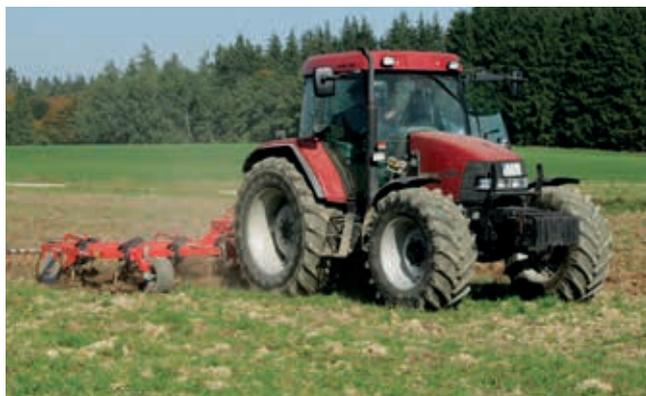
Léger et agile: SuperMaxx® 50-5 BIO attelé à un tracteur 4 cyl. de 100 ch et une masse frontale minime!
