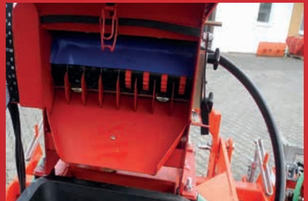
Calibrage du semoir: la quantité semée peut être choisie avec précision grâce à un levier de contrôle sur la gauche, pilotant une boîte de vitesse offrant une large plage de travail.
