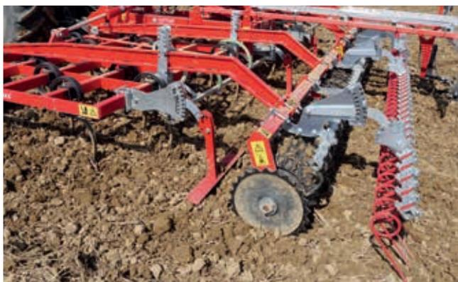
*En option : peigne derrière le rouleau pour lutter contre les mauvaises herbes mécaniquement.*
