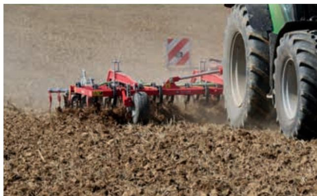
*Les roues de jauge frontales sont recommandées dans la lutte contre les mauvaises herbes, afin de diminuer la pression sur le rouleau.*
