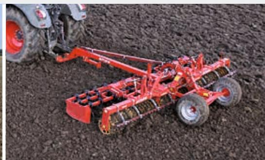
L'outil Avant SX 610-56 U avec essieu et timon, est ainsi converti en machine tractée.
