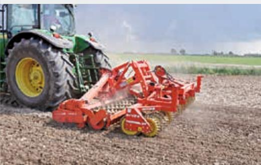
Un rouleau Duplex sans herse frontale dispose d'un attelage 3 points et peut donc être utilisée directement comme rouleau, ou être montée à l'arrière d'une autre machine, sur une herse rotative pour préparer un lit de semences parfait pour les betteraves, colza ou les légumes !
