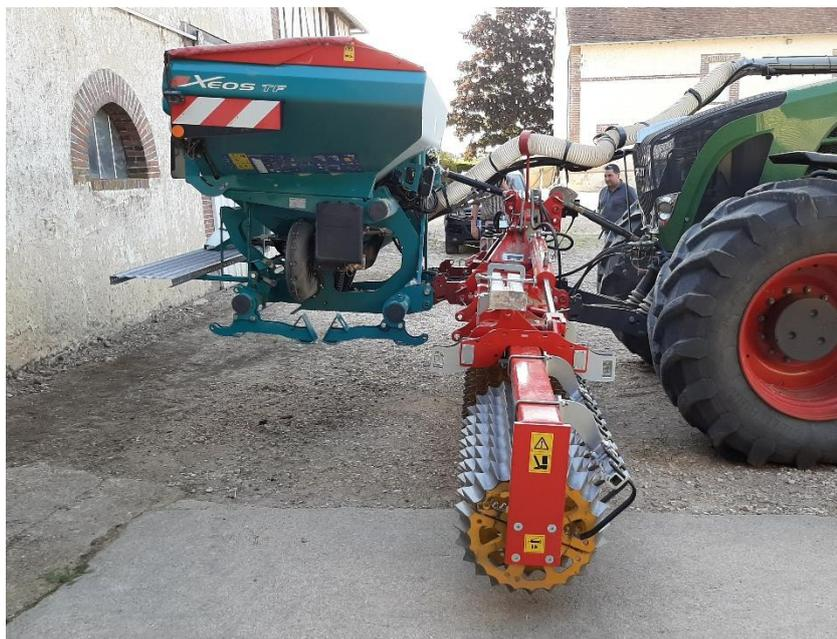
Le rouleau SIMPLEX est équipé de série d'un double attelage. Un attelage standard pour le relevage avant du tracteur, avec plusieurs trous pour un réglage optimal.
